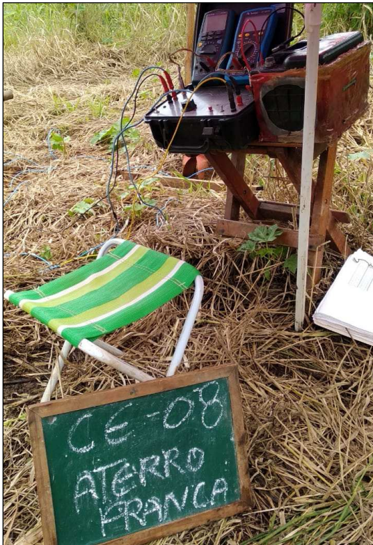
Foto 12 – Execução dos Caminhamentos Elétricos
