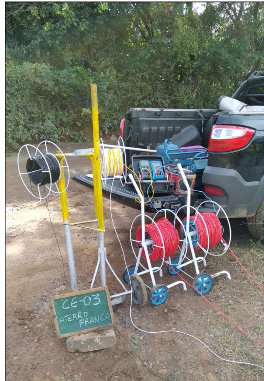
Foto 13 – Execução dos Caminhamentos Elétricos
