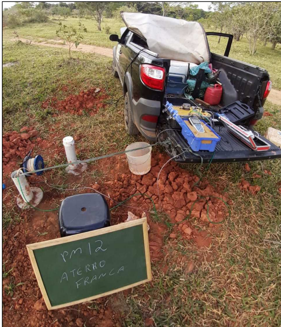
Foto 18 – Coleta pelo método de baixa vazão.
