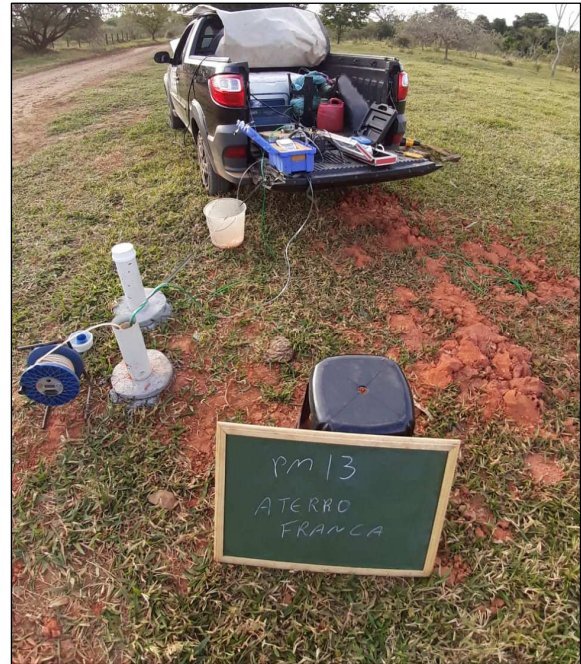
Foto 17 – Coleta pelo método de baixa vazão.
